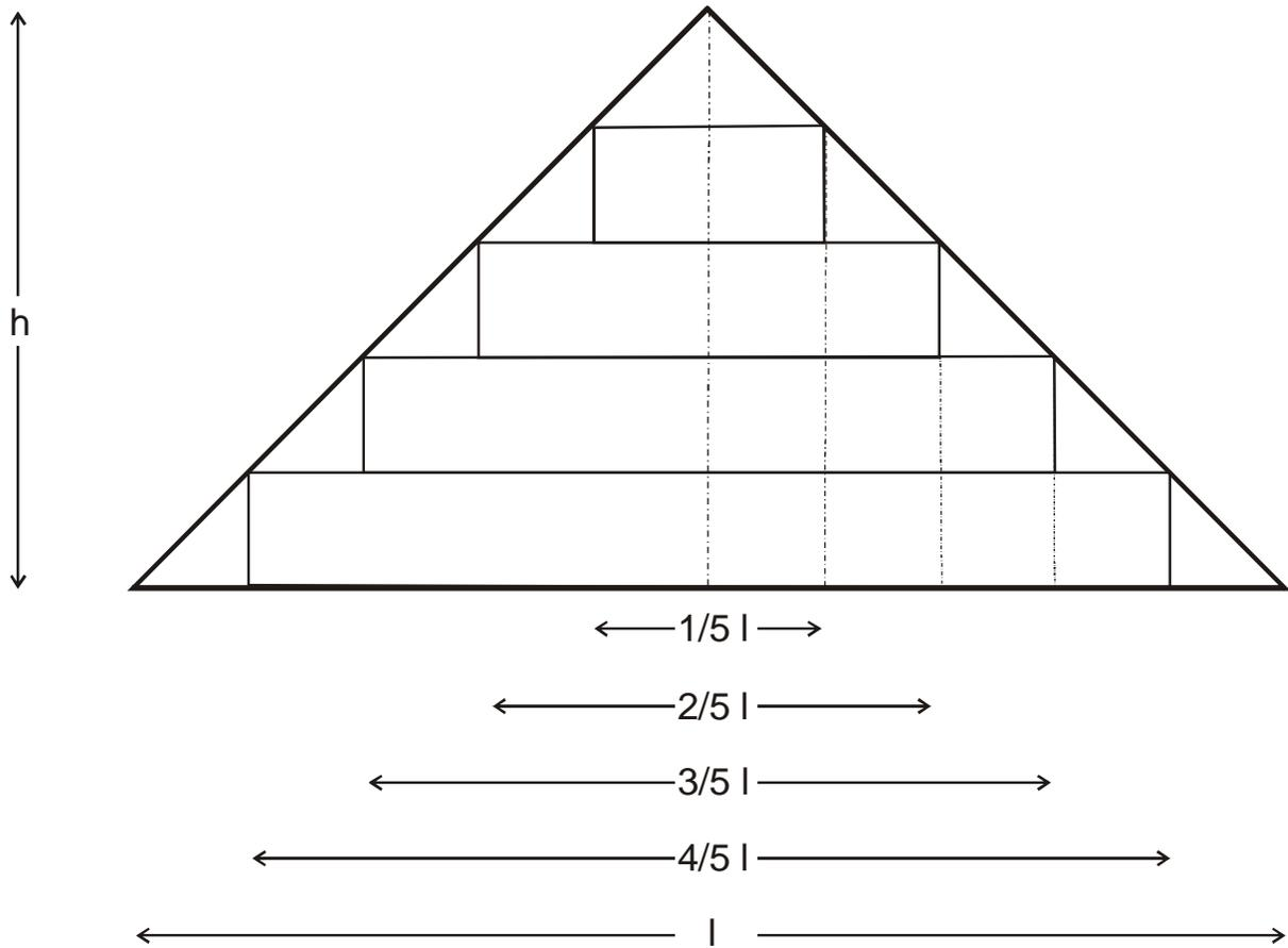
Puesto que la altura  $h$  de la pirámide se ha dividido en 5 partes iguales, la altura de cada bloque es  $h/5$ . El lado de cada bloque cuadrado se obtiene de considerar que el triángulo de la derecha tiene una base dividida también en partes iguales.
